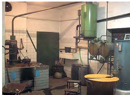
Tradiční dvoukotlové pálenice s procesem přepalování ve Strážnici a Vnorovech (1, 2011).
