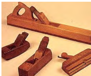
Historické hoblíky vyrobené celé nebo zčásti (kluzná plocha, klínek) z oskerušového dřeva (5, 2007).
