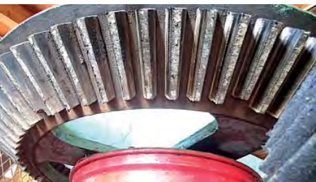
Železné kolo turbíny se zuby z oskerušového dřeva ve vodní elektrárně u Tourmus ve Francii (1, 2013).
