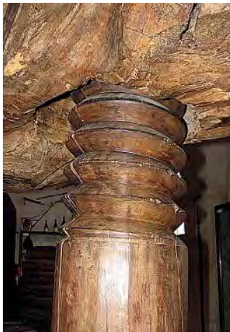
Šroub vinného lisu z oskerušového dřeva z konce 17. stol. z Chateau de Pommard (A. Desbrosse, 2013).
