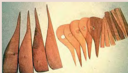
Různé formy „piquettes“ z oskeruše na ruční řezání rolí papíru ze střední Francie (4, 2009).
