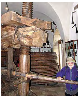
Vinný lis se šroubem z oskerušového dřeva z konce 17. stol. z Chateau de Pommard, Francie (1, 2013).
